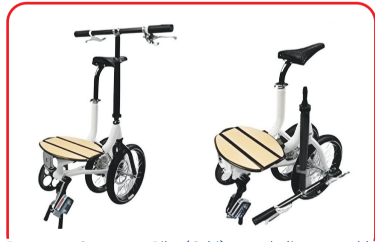
Prototype Commuter Bike (Cobi), sepeda lipat portable multiguna yang dapat menjadi kursi.
