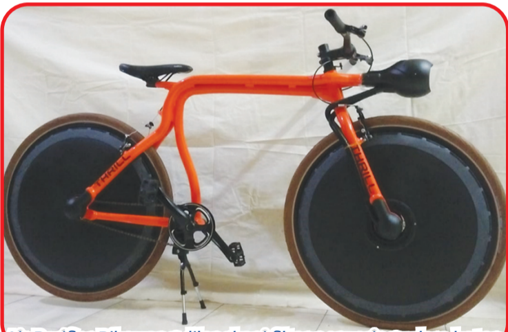
Air Purifier Bike yang dilengkapi filter penyaring udara kotor.
